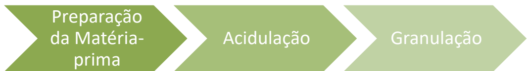
Figura 6 - Etapas do processo produtivo de fertilizantes
