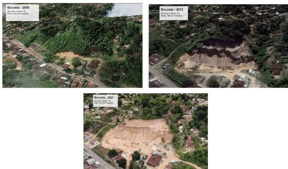
Figura 2 - Conjunto de imagens representativas da redução da cobertura vegetal na encosta analisada e avanço da verticalização do relevo, por anos, 2009, 2015 e 2021.
