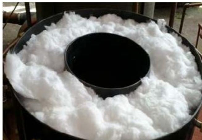
Figura 17 - Câmara de isolamento do reator.
