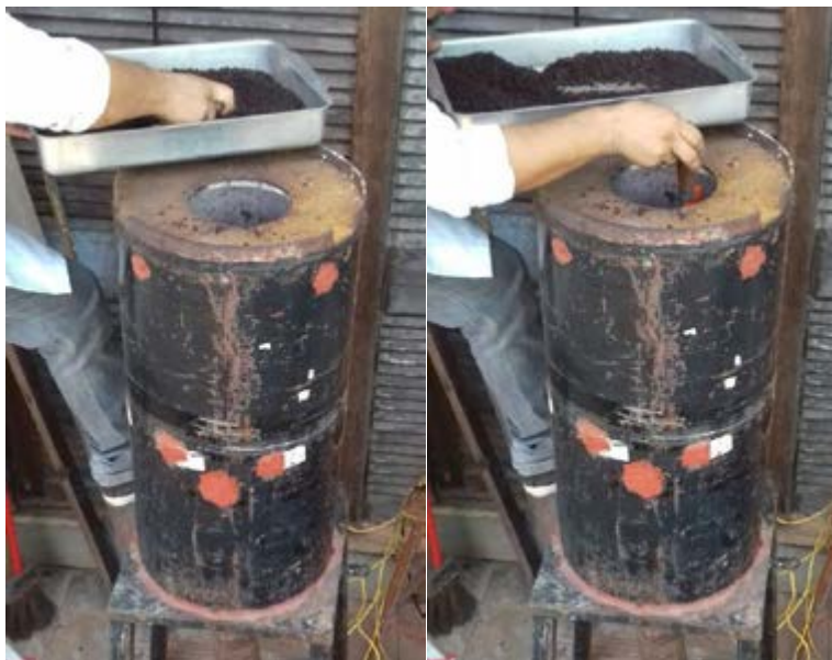
Figura 33 - Abastecimento do leito com o material pelotizado.
