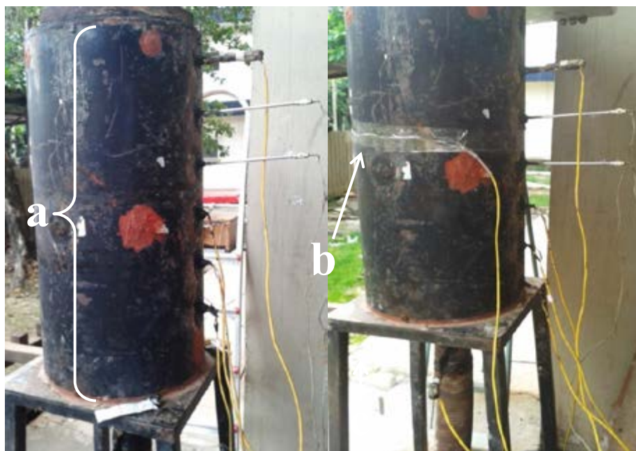
Figura 15 - Reator vertical de leito fixo, a) 7 termopares verticais, b) 1 termopar externo ao redor do reator e c) 1 termopar externo na parte inferior.
