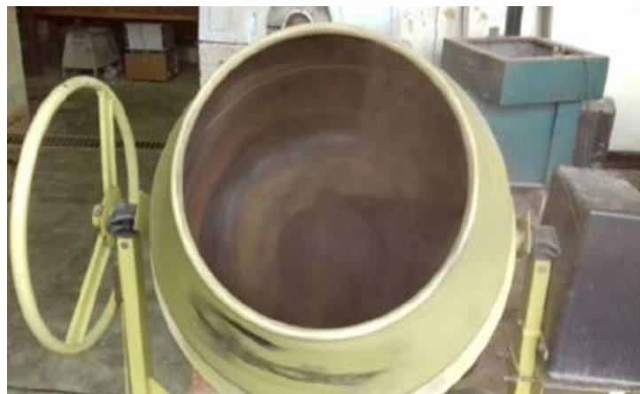
Figura 31 - Betoneira usada na micropelotização.
