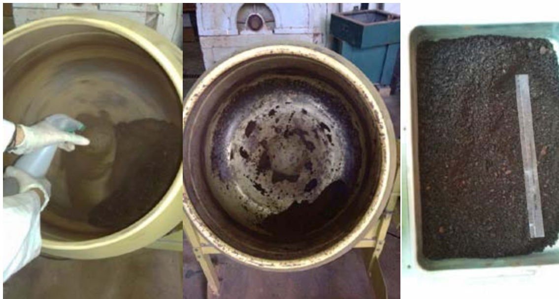
Figura 28 - Processo de micropelotização para determinar o teor de umidade ótima.
