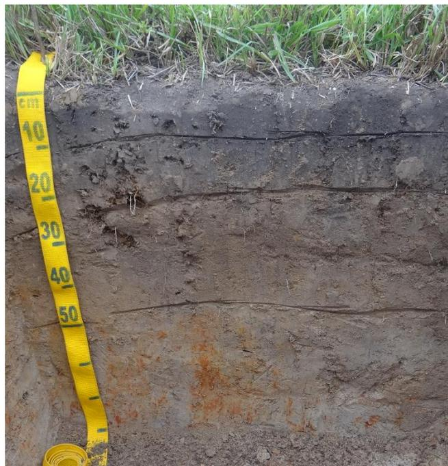
**Figura 4.** Perfil de um Gleissolo Háplico. (Fotografia: Nilson Bardales, 2017).
