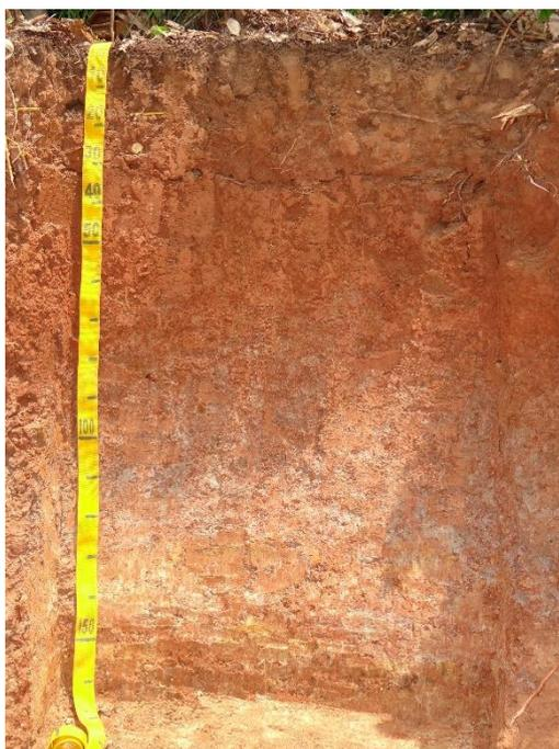
**Figura 6.** Perfil de Luvisolo Crômico. (Fotografia: Edson Alves, 2017).
