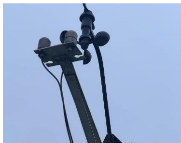
Radiação Solar Global - faixa de medição: 0 a 1280 w/m 2
