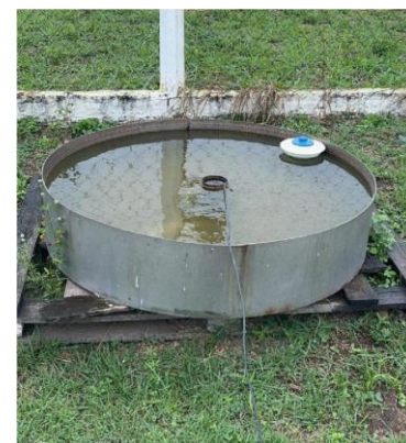
Tanque Classe A – mede profundidade e velocidade da água (evapotranspiração de referência). calcula automaticamente a evaporação da água no tanque e chovendo, ele faz o balanço hídrico
