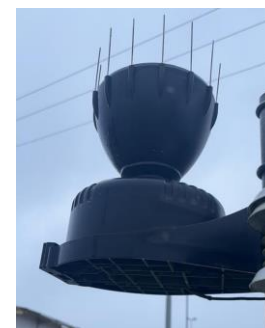
Pluviômetro - faixa de medição: 0-10,2cm/hora Sensor de Umidade do Solo - faixa de medição: 0 a 0,550m³/m³ (0 a 100%)
