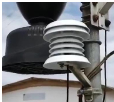
Umidade Relativa do Ar - faixa de medição: 0 a 100% de umidade Temperatura do Ar - faixa de medição: -40° a 75°c
