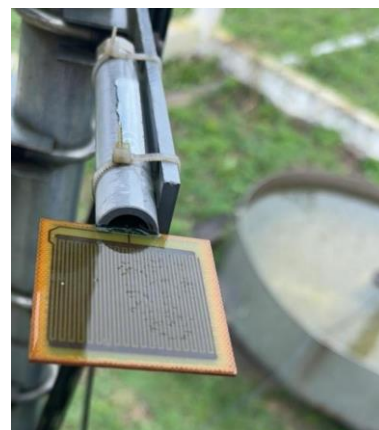
Sensor de Umidade Foliar - faixa de medição: 0% (seco) a 100% (molhado)
