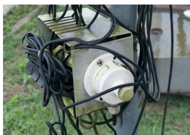
Pressão Barométrica - faixa de medição: 260 a 1260 hpa
