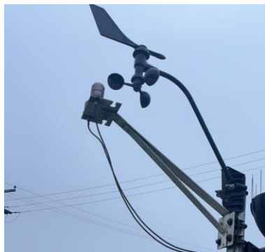
Direção do Vento - faixa de medição: 0 a 355° - biruta Velocidade do Vento - faixa de medição: 0 a 76m/s
