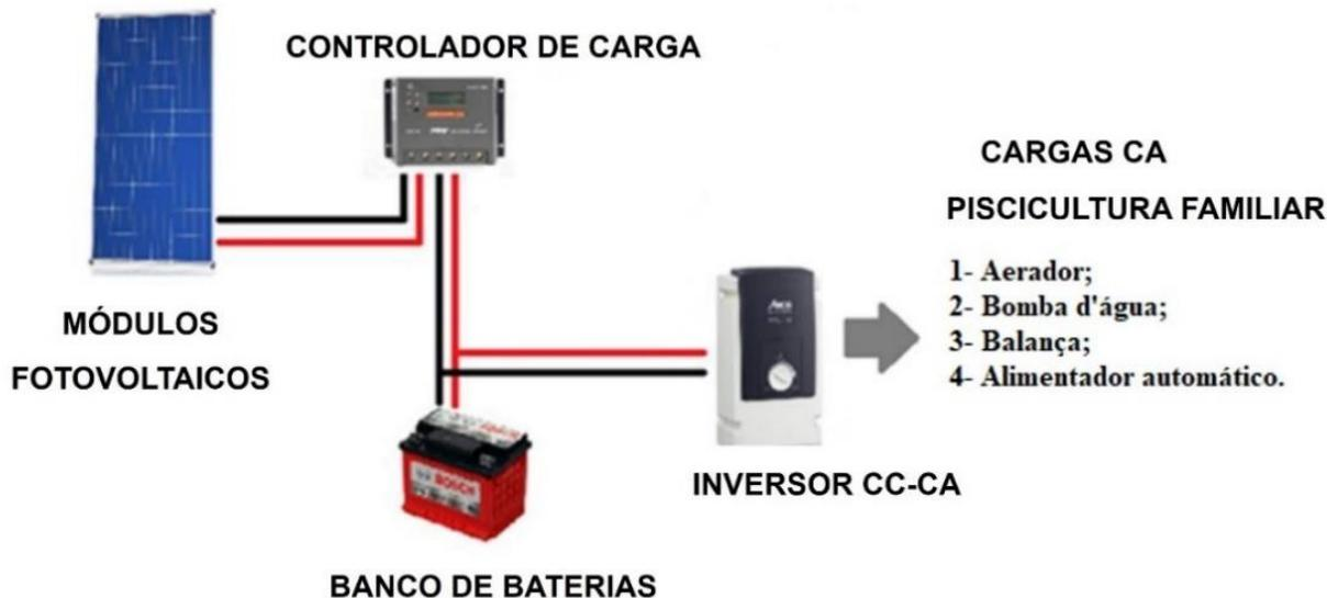
Figura 36. Levantamento de cargas na aquicultura familiar (Adaptado de (Adaptado de Delta Solar, 2021).
