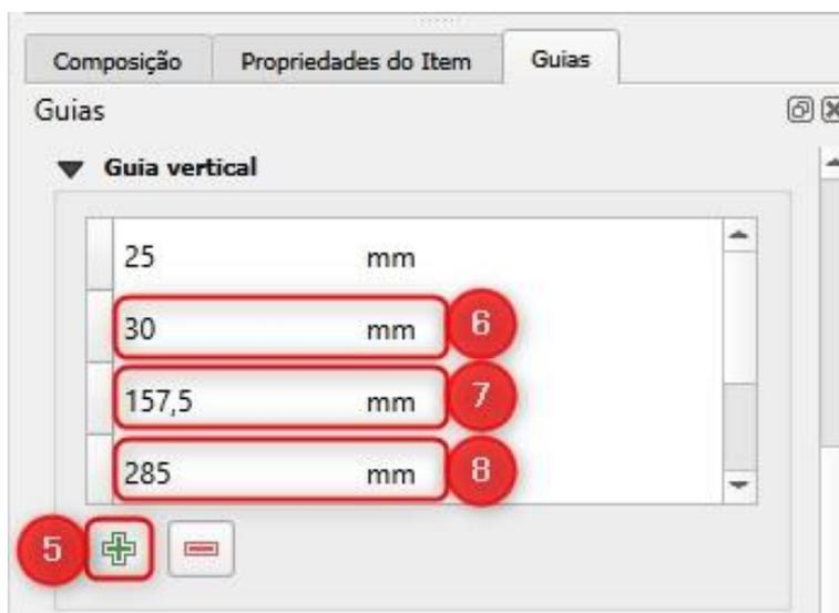
Repare que na sua folha de impressão surgiram 5 guias (2 horizontais e 3 verticais), delimitando a localização das linhas de marcação de centro, conforme especificado pela NBR 10068.
