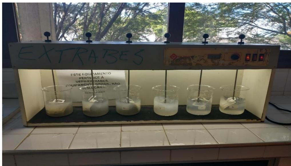
**Figura 1.** Equipamento Jar Test.
